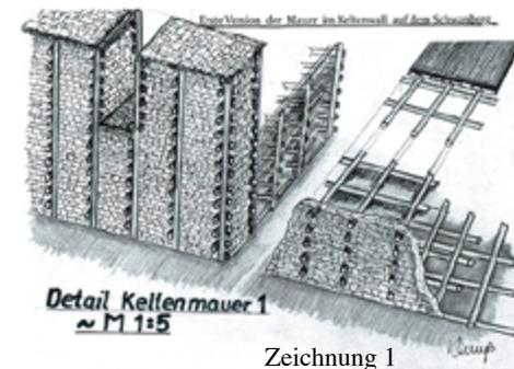
*Links die Mauerfront zur Außenseite. Ein sehr wichtiger Aufbau, wahrscheinlich mit regelmäßigen Öffnungen in der Brustwehr. Auf der rechten Seite sieht man den noch nicht mit Steinen ausgefüllten kastenartigen Holzaufbau, die nach hinten verlängerte Standplattform als Basis für den weiteren Mauerhochbau und später für die Verteidiger.*
